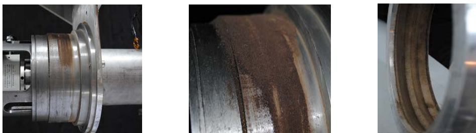
a) 车轮轮轴 b) 轮轴套上剥离的聚四氟乙烯碎片 c) 密封圈内月尘颗粒
