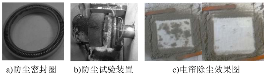
图 1-4 月面装置密封防护及电帘除尘
